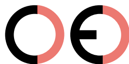
Marcatura CE contraffatta (troppo distante)
